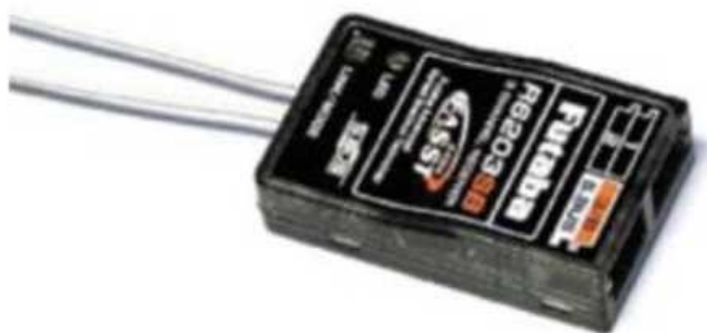
Рис. № 11 - Приемник аппаратуры управления.
