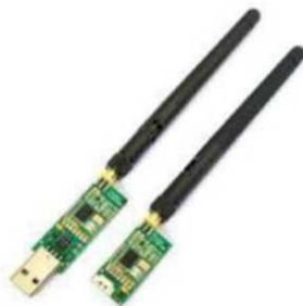
Рис. № 9 - Модем телеметрии.
